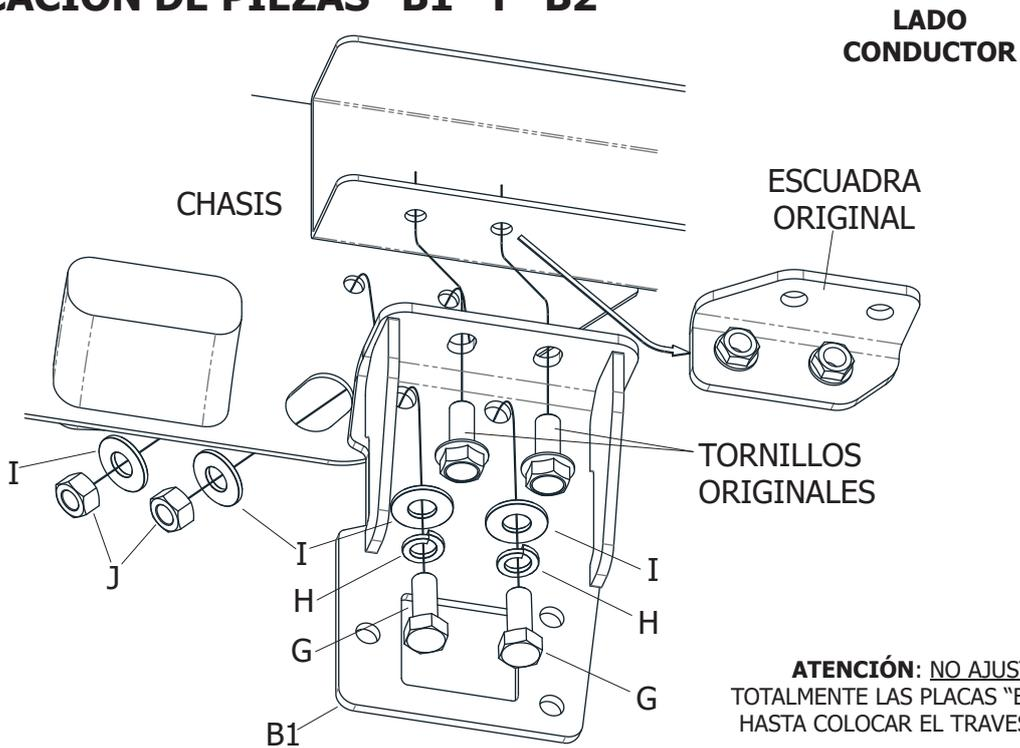
**ATENCIÓN:** NO AJUSTAR TOTALMENTE LAS PLACAS "B1" Y "B2" HASTA COLOCAR EL TRAVESAÑO "A"
